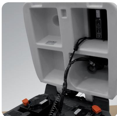
in avanti/indietro. Regolazione della velocità, clacson, interruttore del motore di aspirazione con ritardo di spegnimento. Il serbatoio soluzione detergente serve anche da scomparto batterie, consentendo l'alloggiamento di batterie di elevata capacità. Il carica batterie e il motore di aspirazione sono posizionati sotto il serbatoio di recupero; l'alloggiamento del motore
